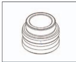
定位销套用于连接固定承载板与边框，并在使用顶升定位单元时达到精度。
